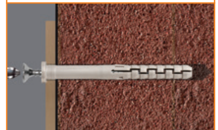
В полнотелом кирпиче
